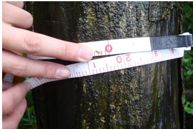
圖 10. 直徑尺測量
